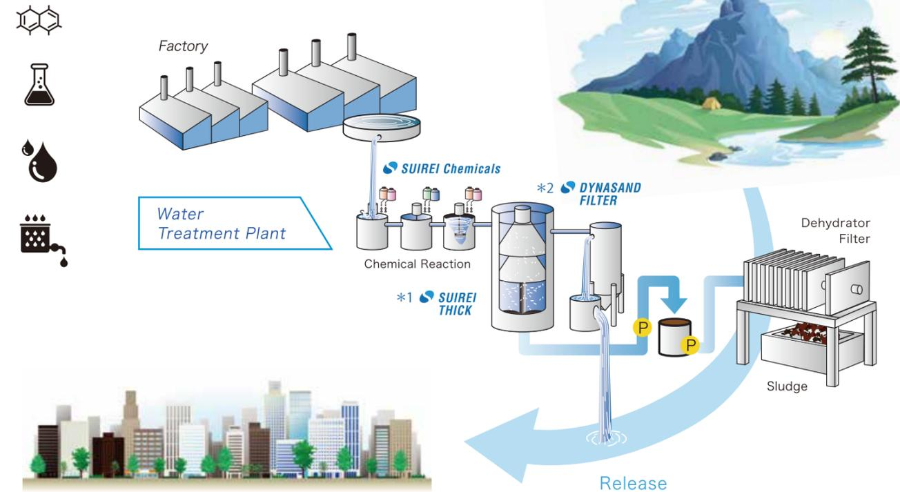
凝集沈殿ろ過システムは、水処理の基礎です。弊社は、お客様ごとに異なる排水の性質に応じて、オーダーメイドのシステムをご提案します。その処理プロセスは、原水槽に集めた工場排水を反応槽に送り、独自ブレンド商品のキレート除去剤や凝集助剤を注入、薬品反応させることから始まります。ここで酸化還元中和 / 反応などを行い、排水に含まれる物質に対して、適確な凝集の前処理を施します。
