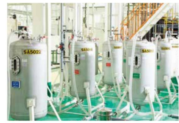
水処理システムとは、工場排水に含まれる有害物質を取り除き、公害を防ぐ仕組みです。一般的には工場の生産ラインで利用された水（排水）を、人体や自然環境に害のない放流基準値まで浄化し、河川や下水に放流するまでの設備を指します。弊社では従来の水処理システムを一步前に進め、排水を放流するのではなく、浄化された水を再び生産ラインに戻し、工場内で永続的に循環させる『リサイクル水処理システム』をご提案しています。従来の水処理システムは、排水に含まれる有害物質のほとんどを除去しますが、塩分などの不純物は残ります。この段階の水は、IT機器の基板や精密な航空機関連部品の洗浄には利用できないものです。しかし上図のとおり、弊社のリサイクル水処理システムでは「セミ・クロード型」で70%、「完全循環型」では100%に近い比率で工場排水をリサイクルできるため、お客様の社会的責任を果たすことを実現させています。
